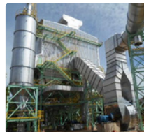
Filtros de Mangas tipo Ar Reverso para Ferro Ligas, Mangas com \varnothing 300 mm x 10.500 mm
