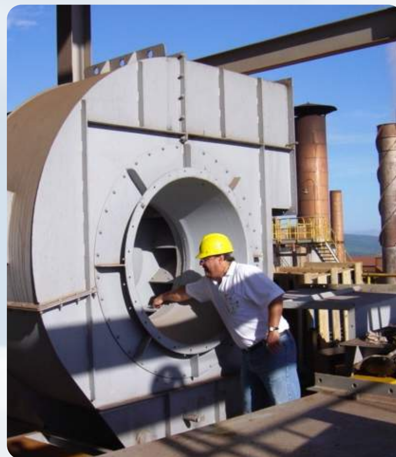
VENTILADOR PARA DESPOEIRAMENTO DE SECADOR DE MINÉRIO
