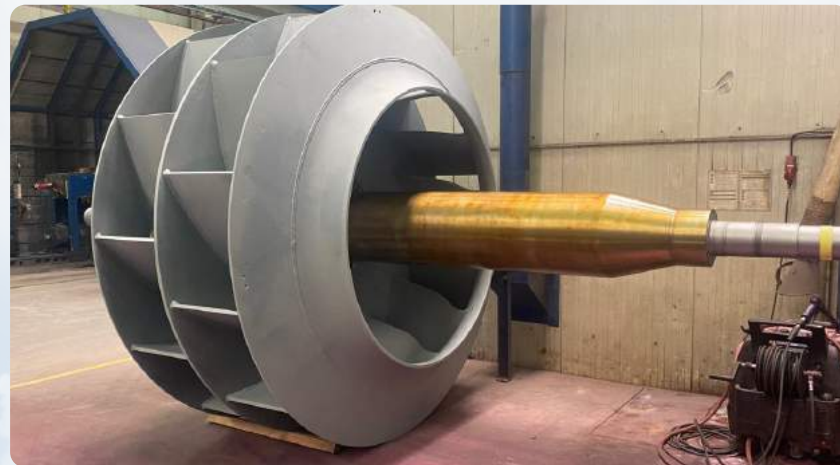
ROTOR DO VENTILADOR DESPOEIRAMENTO PROCESSO SIDERÚRGICO
