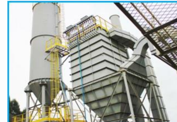
Despoeiramento de Processo Aeroclassificador para Areia
