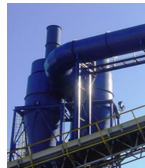
Pátio de Sucata (Schredder Plant) Ciclone Defagulhadores Modelo 1235 VM 810 / 150 TWIN
