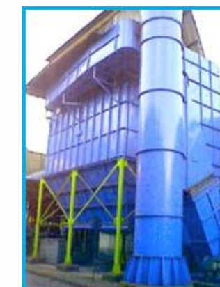
Despoeiramento Processo de Fundição
