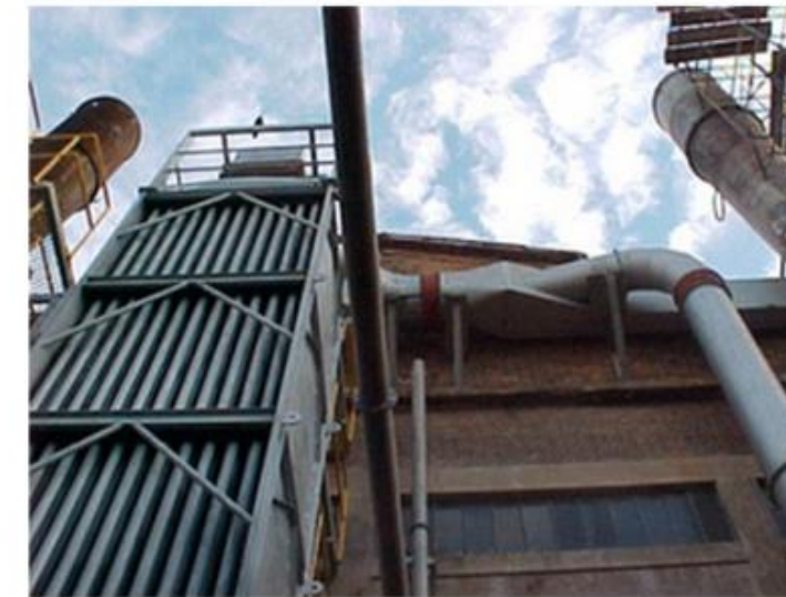
Forno de Fusão de Vidro com Trocador de Calor antes do Filtro de Mangas. Resfriamento com Ar Forçado por Ventiladores
