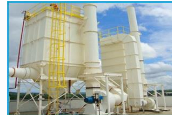
Despoeiramento Pontos de Transferência - Detergente em Pó
